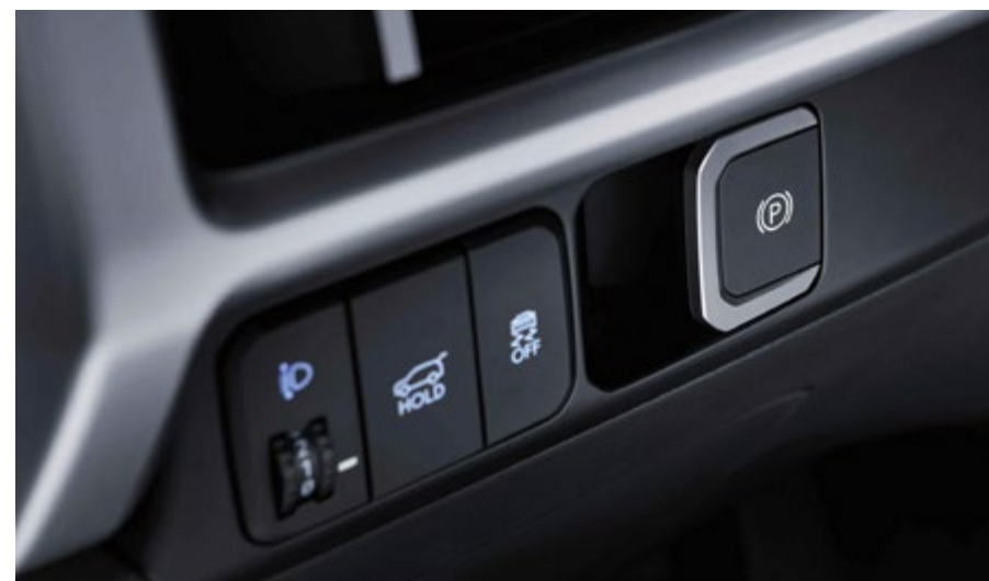
Elektrische Parkbremse mit Auto Hold Funktion (EPB)
