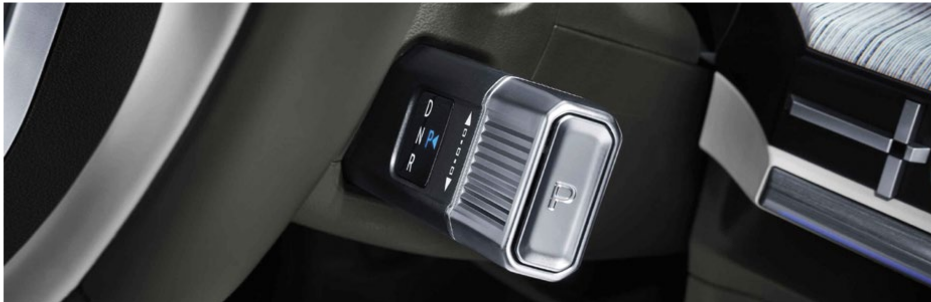
Shift by Wire - elektronische Steuerung der Gangwahl
